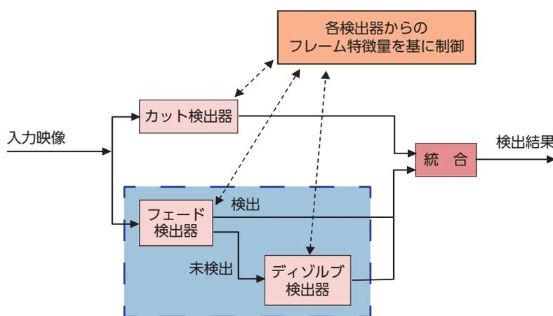
図 カット点検出処理の概要
