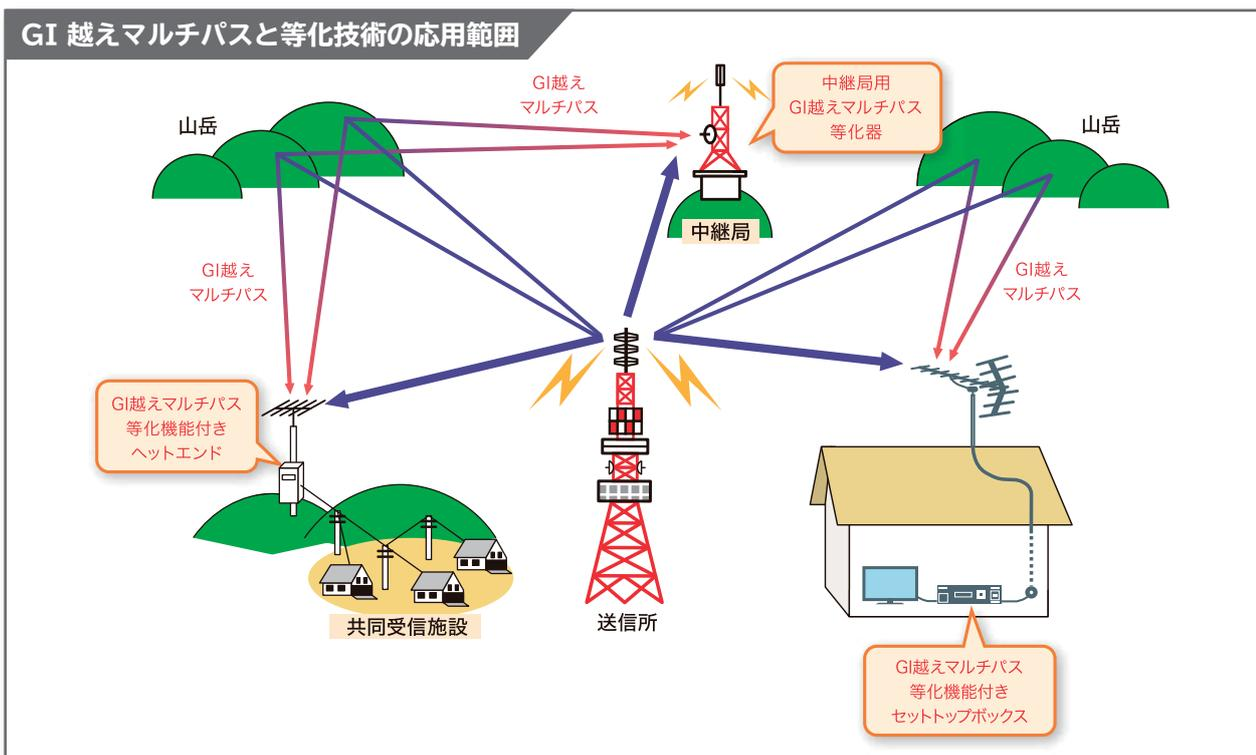
地上デジタル放送においては、遠方の山岳などからの反射波や、他の SFN（単一周波数ネットワーク）送信局からの放送波などにより、遅延時間差の大きいマルチパス波が受信され、受信信号品質が劣化する場合があります。マルチパスとは送信された電波が、伝搬時間の異なる複数の経路を通過して受信アンテナに到達し、受信される現象のことです。アナログ放送では、映像が二重や三重に見えるゴーストと呼ばれる障害になります。しかし、デジタル放送では、受信した信号の“0”、“1”を判定して映像を再生するためゴースト障害にはなりません。しかし、受信信号から正しい映像を再生できなくなる原因になることがあります。
