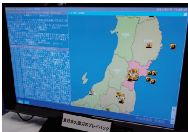
写真4 ツイッターから自動で異常検知／情報収集するシステム
