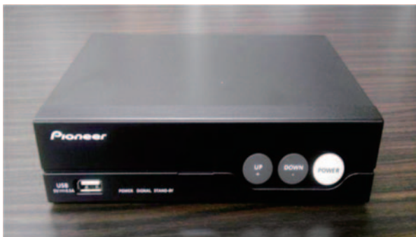
図3 マルチバンドISDB-T長遅延対応セットトップボックス
