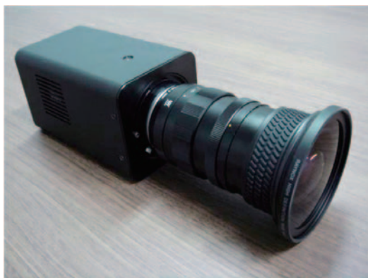
図4 宇宙用の超高感度CMOSカメラ
