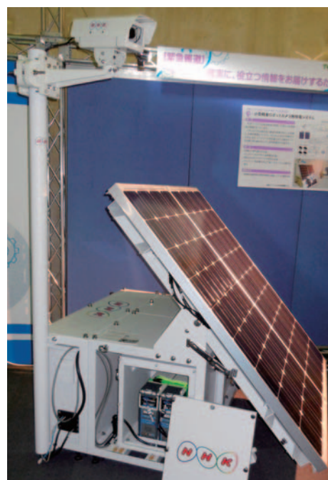
写真7 小型軽量ロボットカメラ無停電システム
