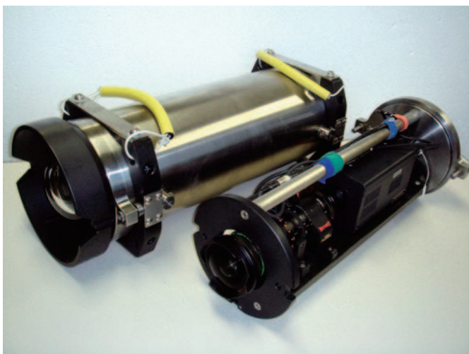
写真2 深海用水中ブリンプと超高感度EM-CCDカメラ
