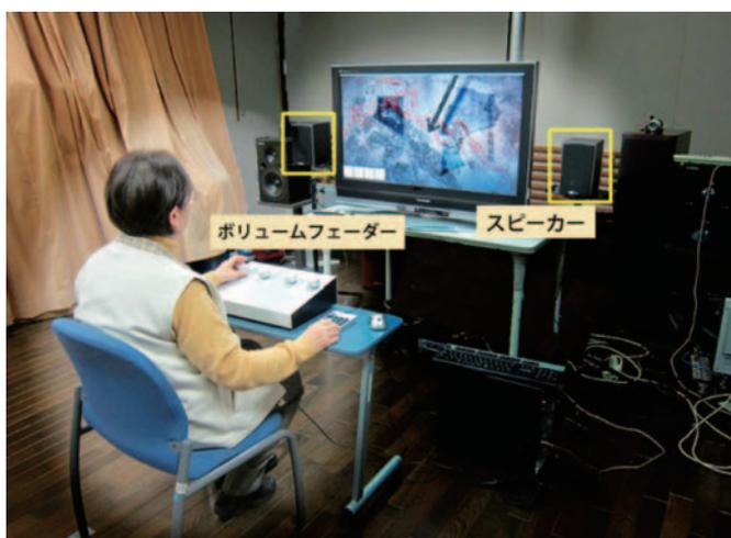
図4 ボリュームフェーダーを使って調整する実験
