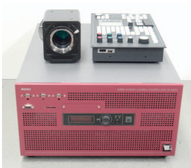
写真4 システム外観 (上左: カメラヘッド、上右: リモコン、下: CCU)
