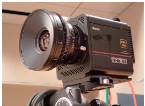
写真4 産業向け小型8K単板CMOSカメラ
