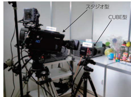
写真2 8K単板カラーカメラ（左：スタジオ型、右：CUBE型）
