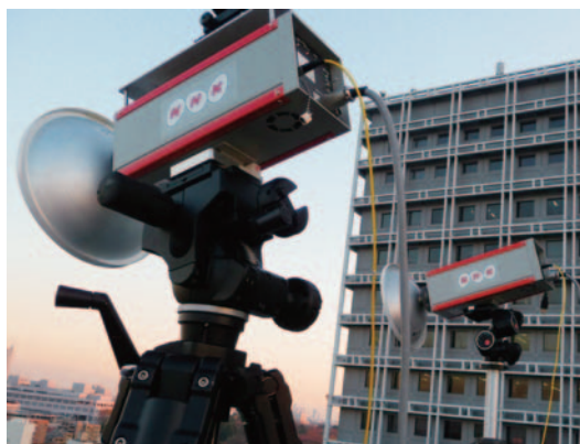
写真2 野外実験の様子（送信点）
