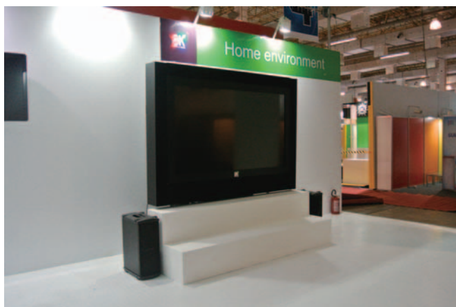
写真2 85インチ8K LCDと枠型スピーカー
