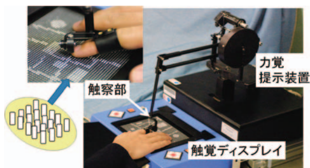
図3 触覚ディスプレイと力覚誘導の複合提示方式
