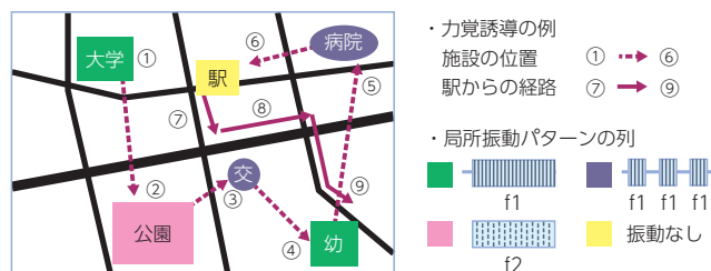
図4 局所振動と力覚誘導の動作を説明する図
