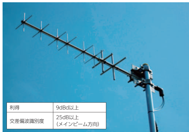
写真2 偏波共用八木アンテナの外観
