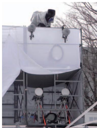
写真1 雪まつり会場に設置した8Kカメラと120GHz帯FPU
