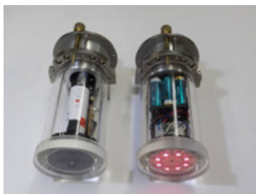
写真4 4K小型深海カメラ（左）と近赤外LED照明装置（右）
