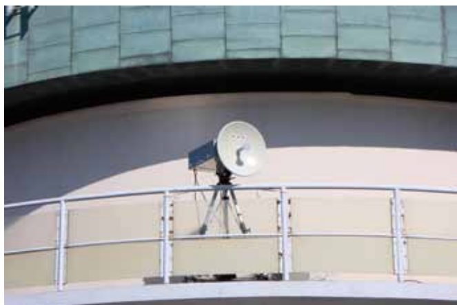
写真1 送信側のアンテナ設置状況
