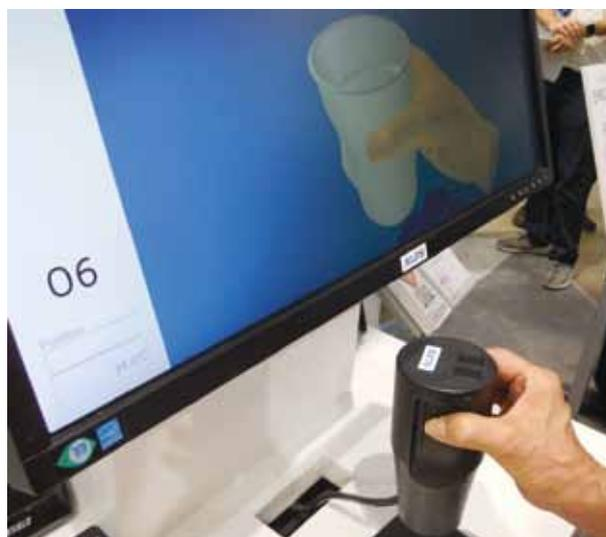
写真3 力覚をフィードバックする技術 (アルプス電気)
