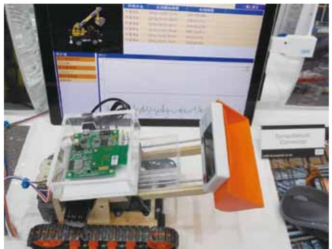
写真5 作業車の屋内位置や稼働状況を可視化する技術（ローム/ラピスセミコンダクタ/ISID）
