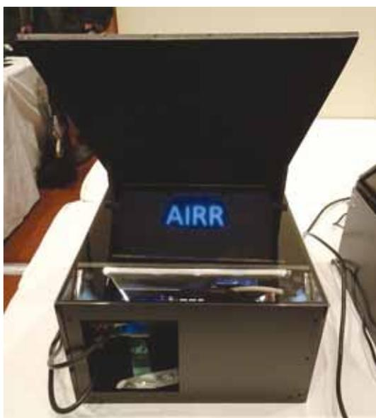
写真3 再帰反射型空中ディスプレイ
