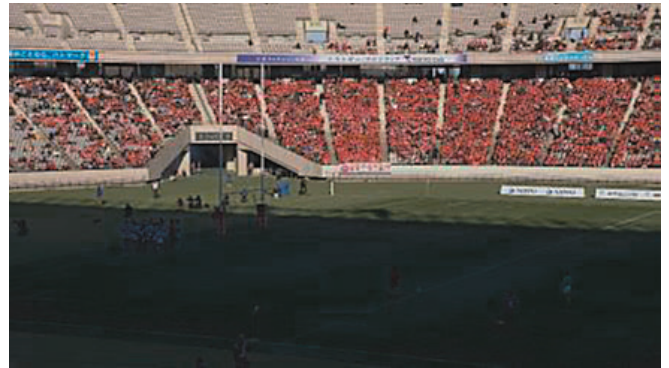
(b) 単にゲインを下げた場合。暗部が黒くつぶれている。
