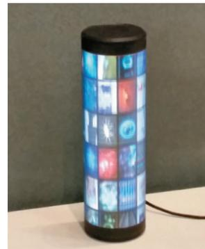
写真2 フレキシブル液晶ディスプレイ
