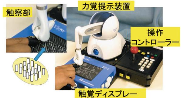
図1 触力覚提示システムの外観
