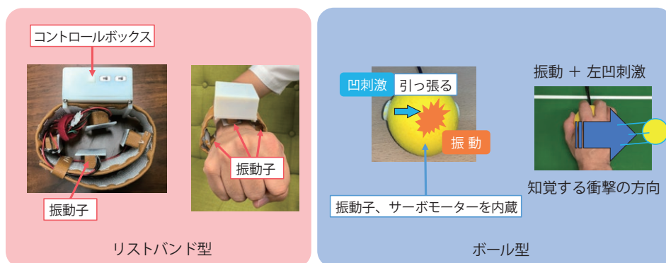
図2 開発した触覚インターフェース（左：リストバンド型、右：ボール型）
