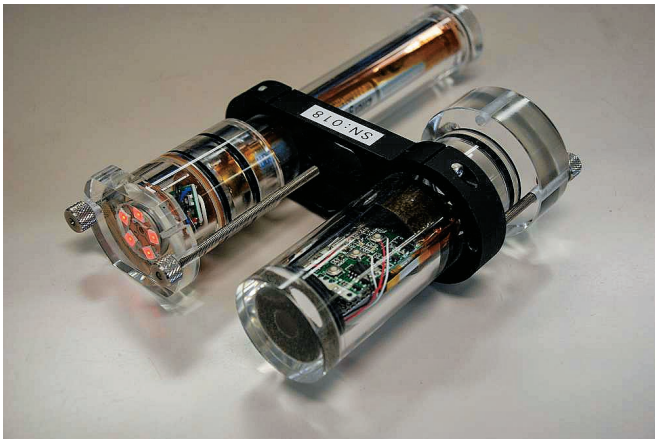
図4 小型ドロップカム (左は近赤外線照明)
