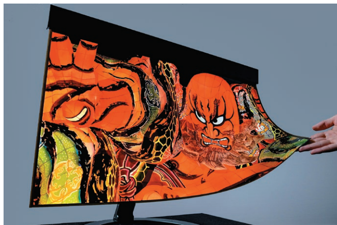
図 試作した30インチフレキシブル有機ELディスプレイ
