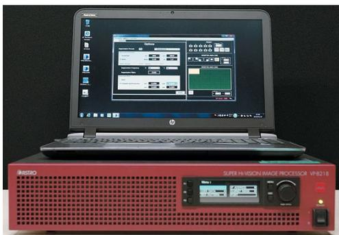
図3 符号化前処理装置と制御PCの外観
