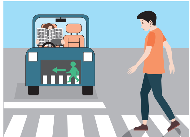
図3 自動運転車が歩行者に安全に横断できることを伝える車外ディスプレイの応用イメージ
